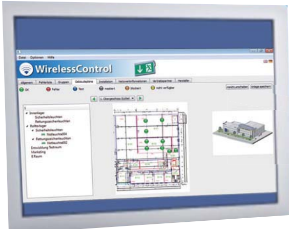
Gebäudepläne können in der Steuerungssoftware hinterlegt werden. / Ground plans can be visualized.
